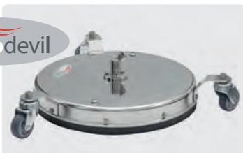
Laveurs de surfaces avec nouveau raccord rotatif articulé conçu pour résister à des vitesses de rotation élevées. L'articulation du raccord rotatif permet une grande liberté de mouvement pour la lance et par conséquent une manipulation sans fatigue. Ils sont équipés de 3 roulettes pivotantes (60 mm). Prévoir deux buses 1/4" M de 15°. Max. 1.800 l/h / 60 °C / 275 bar
