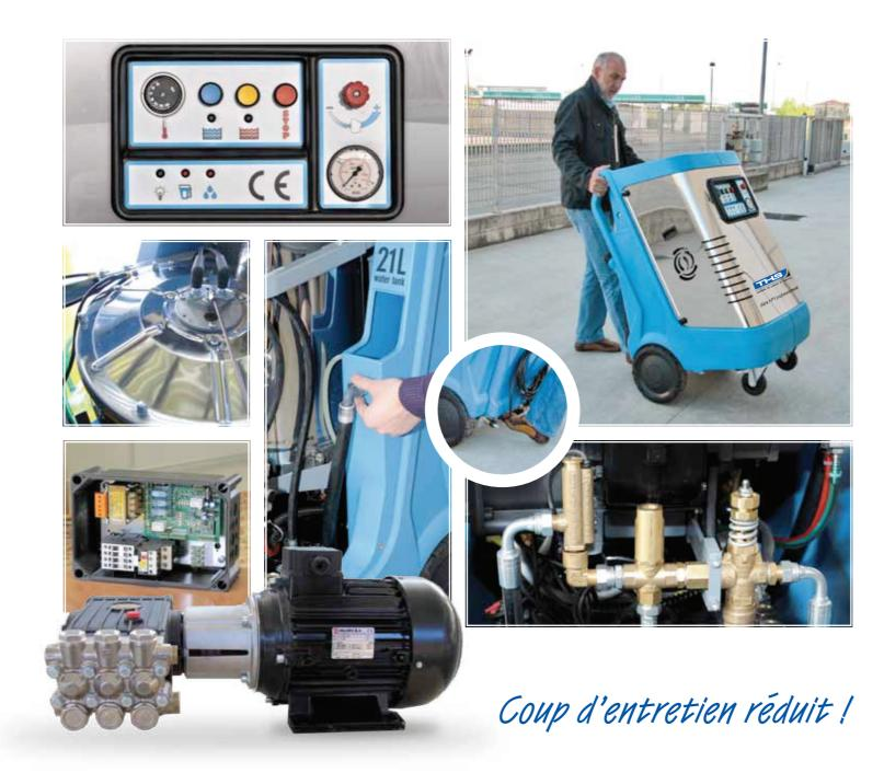
Tous les modèles de la gamme HPV sont équipés de : • Pompe Interpump série 47 • moteurs électriques IP55 (protection totale contre les jets d'eau) • Accouplement élastique du groupe moteurpompe • Commande par boutons poussoirs en basse tension (24V) • Vanne de réglage de la pression • Soupape de sécurité • Pressostat • Flussostat de sécurité • Filtre sur entrée d'eau • Filtre d'eau en aspiration • Filtre détergent avec clapet anti retour • Filtre gasoil en ligne.
