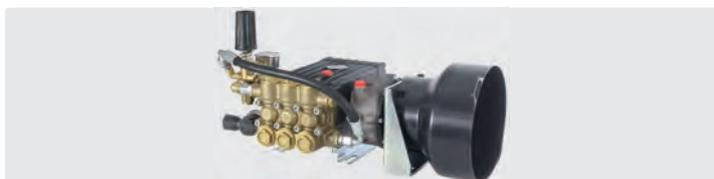
Prêt-à-monter. Pompe haute-pression avec vanne by-pass ST-280, manomètre 0-250 bar, flexible by-pass et filtre d'entrée d'eau ST-33. Température d'alimentation d'eau jusqu'à 30 °C
